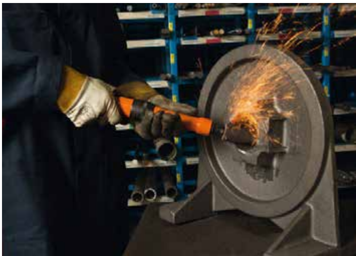
Ponçuses Cleco de 236 série pour les travaux d'ébarbage sur les pièces de fonte - grâce à la caisse étroite Vous arrivez à toutes points d'affûtage
