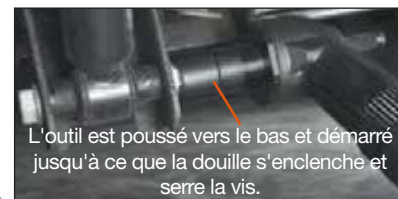
La douille Hold & Drive est fixée sur la vis et évite sa rotation.
